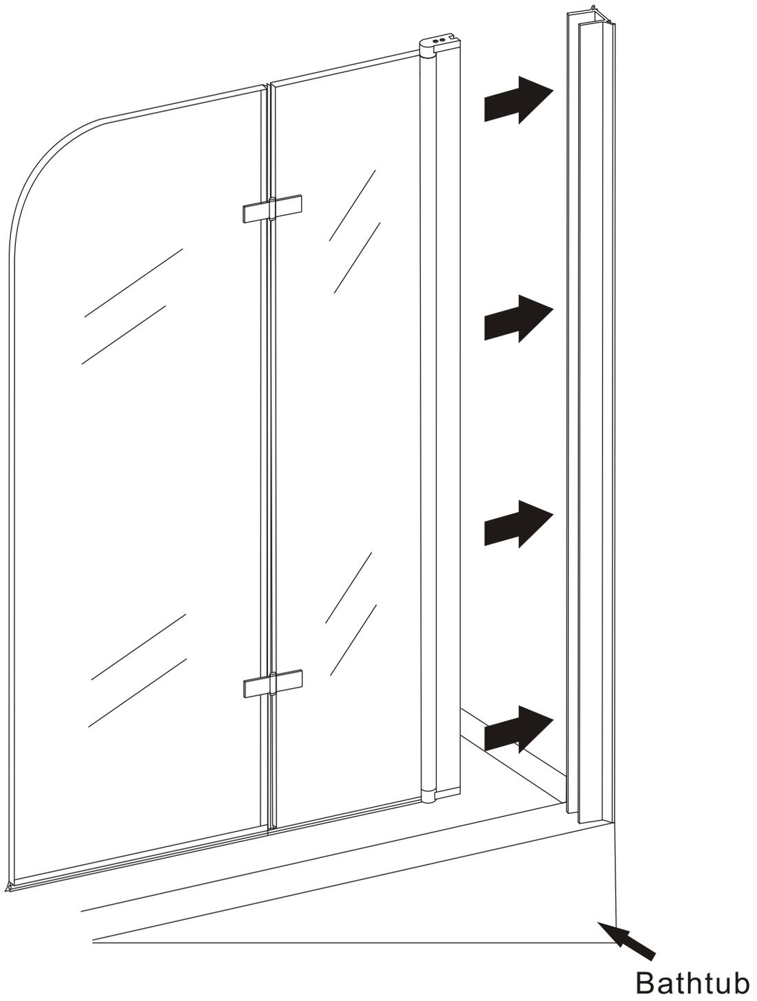
Schrauben Sie an den vorgesehenen Stellen von außen durch das Wandprofil und fixieren Sie das 1. Element, bringen Sie anschließend die Abdeckkappen zwecks Verdeckung der Schrauben an. Nehmen Sie auch hier eine Wasserwaage zur Hilfe
