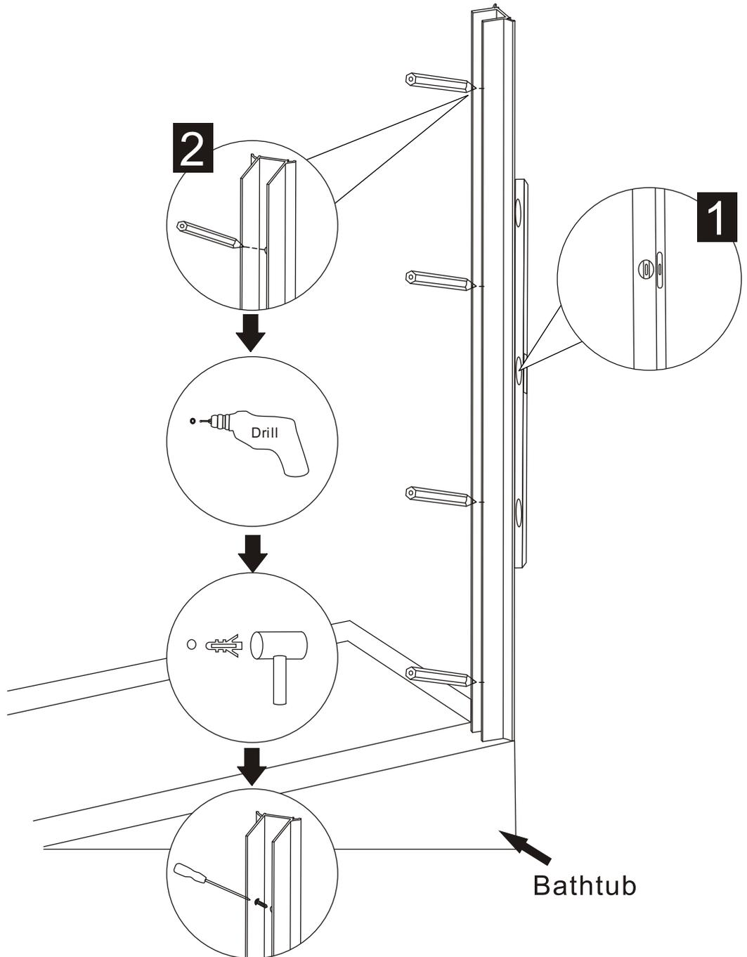
Verschrauben Sie das 2. Element mit den Scharnieren
