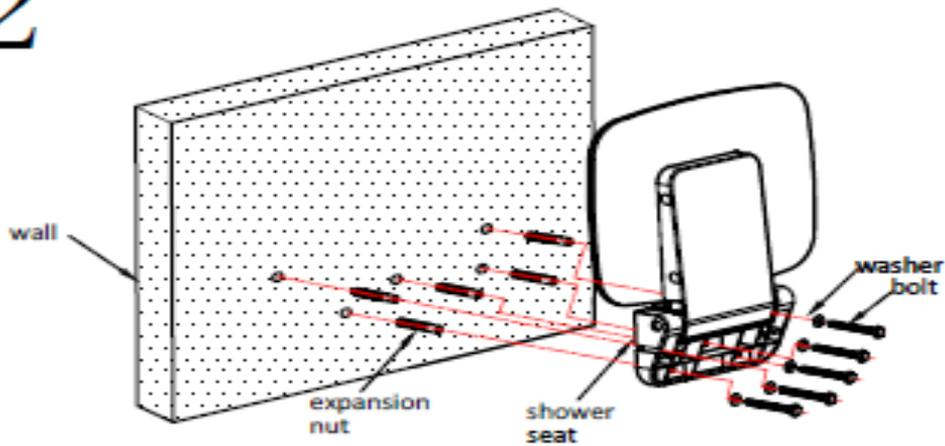
Führen Sie die Stahlschrauben in die Unterlegscheiben und schieben Sie diese von außen durch den Duschsitz in die Bohrlöcher. Ziehen Sie anschließend die Schrauben fest an
