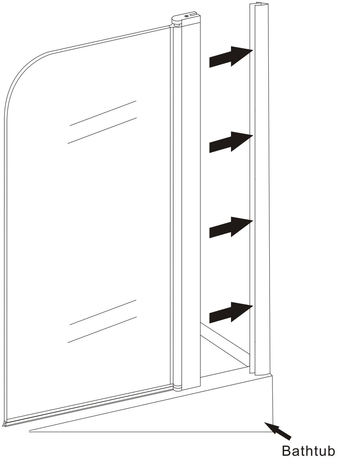
1. Bohren Sie an den vorgesehenen Stellen durch das Wandprofil und fixieren Sie die Abtrennung mittels der beigefügten Schrauben
