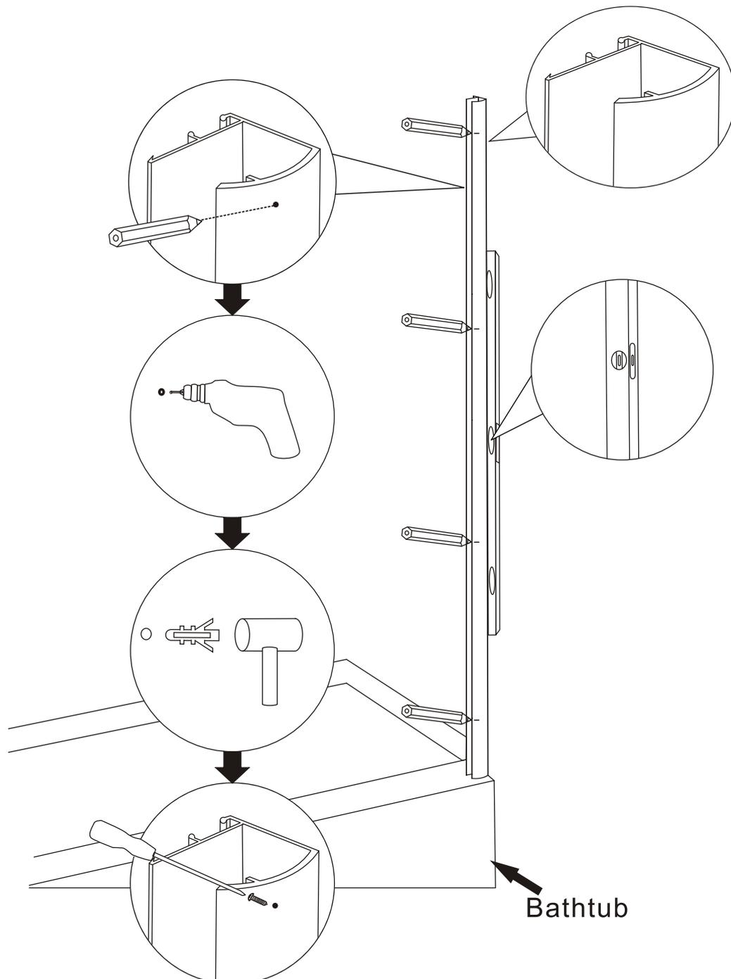
Installieren Sie die untere Dichtleiste und passen diese wie abgebildet an
