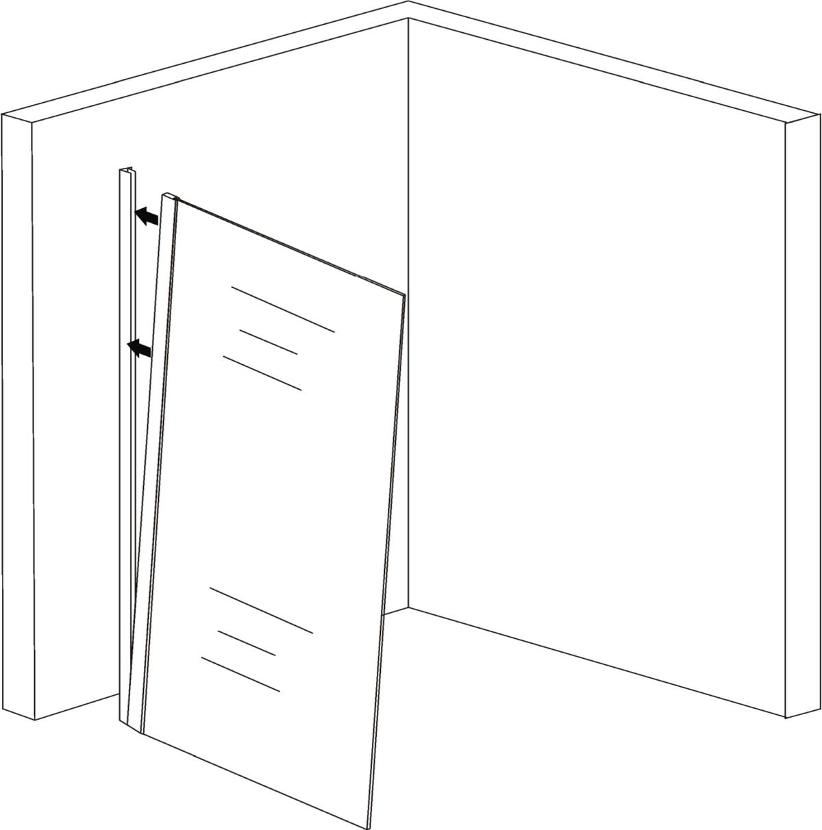
1. Bohren Sie an den vorgesehenen Stellen durch das Wandprofil und fixieren Sie die Duschwand mittels der beigegefügten Schrauben
