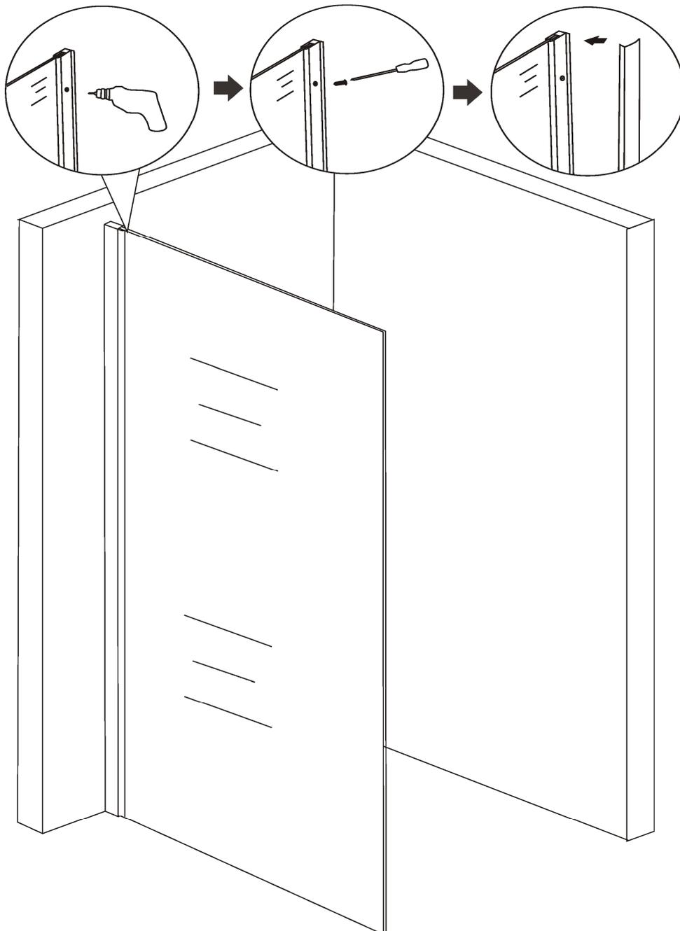
Bringen Sie die obere Profilabdeckung an und versiegeln Sie die Duschwand von innen & außen mittels Silikon
